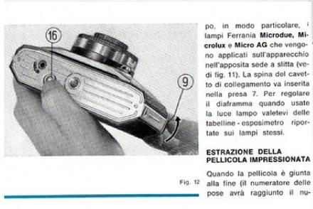
po, in modo particolare, i lampi Ferrania Microdura, Microdura Micro AG che vengono applicati sull'apparecchio nell'apposita sede a slitta (vedi fig. 11). La spina del cavo di collegamento va inserita nella presa 7. Per regolare il diaframma quando usate la luce lampo valatevi delle tabelline - esposimetro riportate sui tempi stessi.
