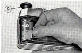
Premendo sulle sue flange dentate, fate rotare la bobina ricevitrice 17 (fig. 5), in modo che la sua fenditura 18 si presenti verso l'esterno. Ripiegate in dentro per circa mezzo centimetro l'estremità
